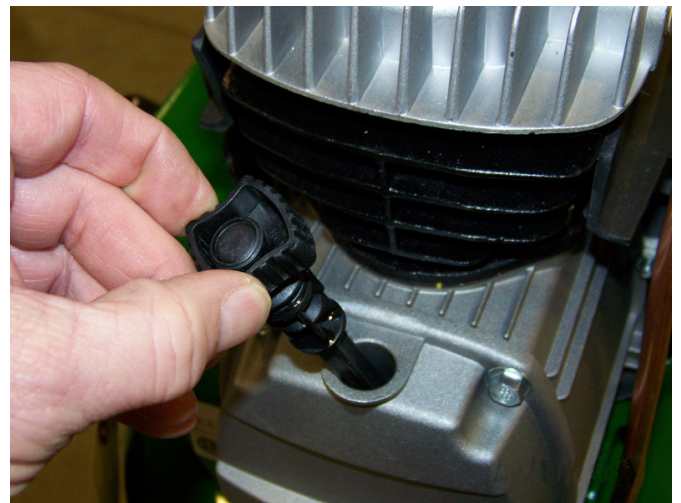
2. Installez la prise d'huile/passage
